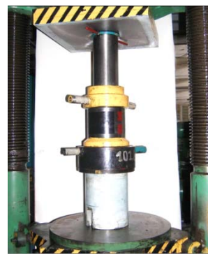
Рис. 2. Оснащення для редукування шліцьових втулок, яке встановлене на гідравлічному пресі моделі ІПС-200:
